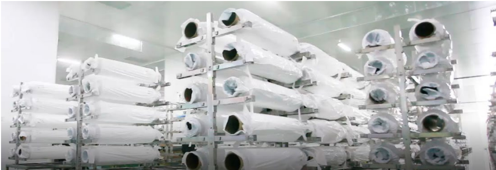
Figur 8. Färdig basfilm, redo för beläggning (steg 2). Bild från Seniors tillverkning i Kina.
