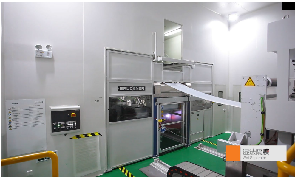
Figur 11. Bild från en av Seniors fabriker i Kina (Changzhou). Tillverkningen sker i renrum med hög automatiseringsgrad.
