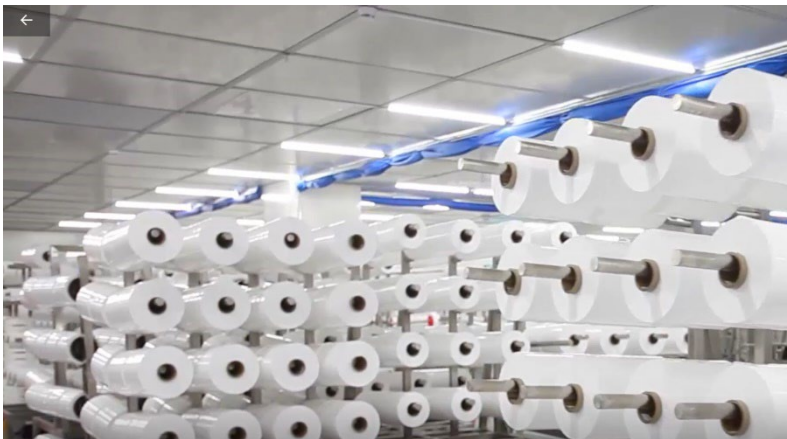
Figur 10. Separatorfilm på rulle, färdig för leverans till kund. Bild från Seniors tillverkning i Kina.
