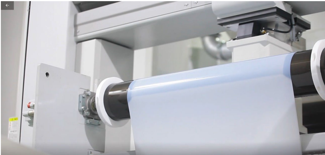
Figur 5. Polyetenfilm på rulle. Bild från Seniors tillverkning i Changzhou i Kina.
